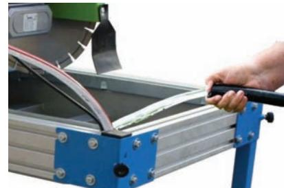
Во время резания в поддон попадает много пыли, поэтому воду нужно менять по мере необходимости, чтобы обеспечить стабильную работу насоса и достаточное охлаждение диска. Для этого в поддоне имеется сливная пробка.
