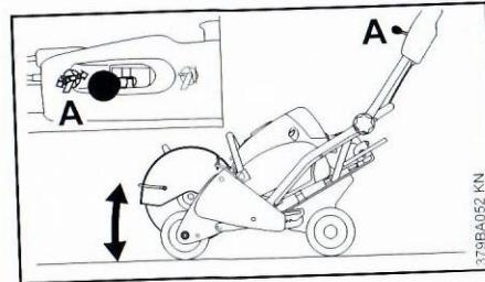
Для регулировки желаемой глубины реза и для погружения в рез.
