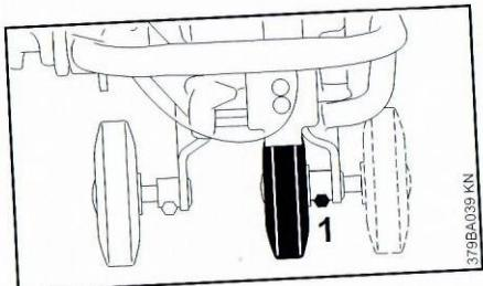
Для резки вплотную вдоль бордюрных камней благодаря переустановке правого колеса снаружи вовнутрь можно не переустанавливать отрезной круг на "внешнее положение монтажа".
