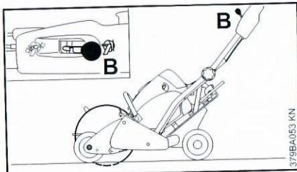
Для фиксации отрегулированной глубины реза и для работы с равномерной глубиной реза.
