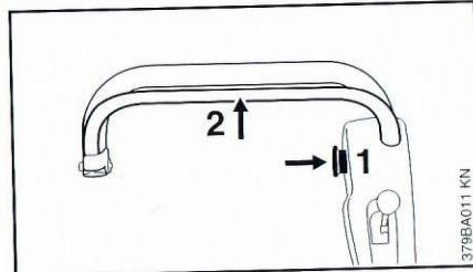
Управление дроссельной заслонкой происходит не с помощью рукоятки на абразивно-отрезном устройстве, а через управление дроссельной заслонкой на направляющей трубке.
