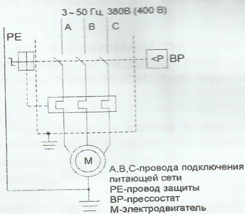
Рисунок А.2 - Схема электрическая принципиальная компрессоров СБ4/С-50.LB30, СБ4/С-100.LB30, СБ4/С-100.LB30В
